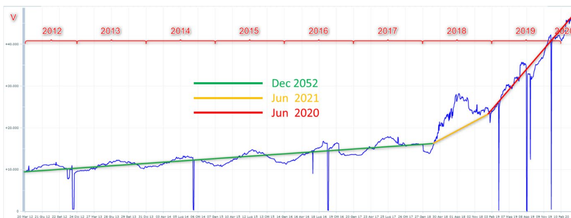
Figura 3 – Ejemplo de duración residual de los ánodos ICCP en un alimentador
