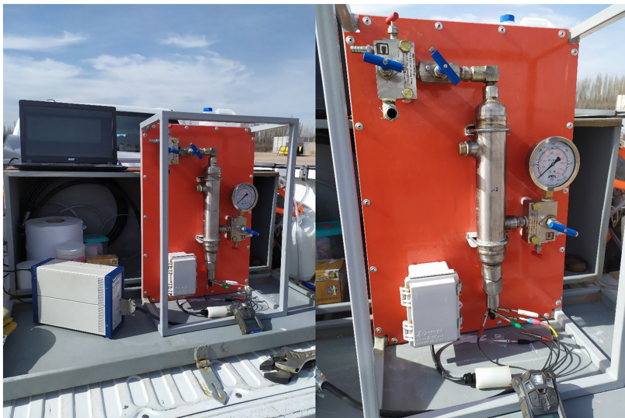
Figura 5: Conexión del sistema integrado a la interface electroquímica de medición.
