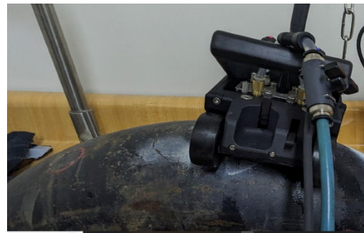
Imagen 8 Zona para la inspección radio exterior del codo de 90° y 45°
