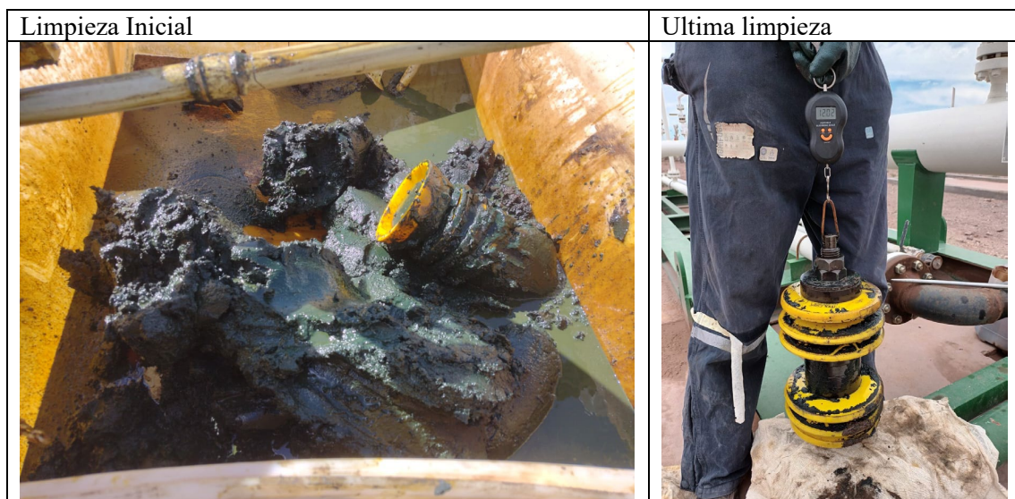
Figura 9. Limpiezas previas y post a la implementación de pasajes de scrapper periodicos
