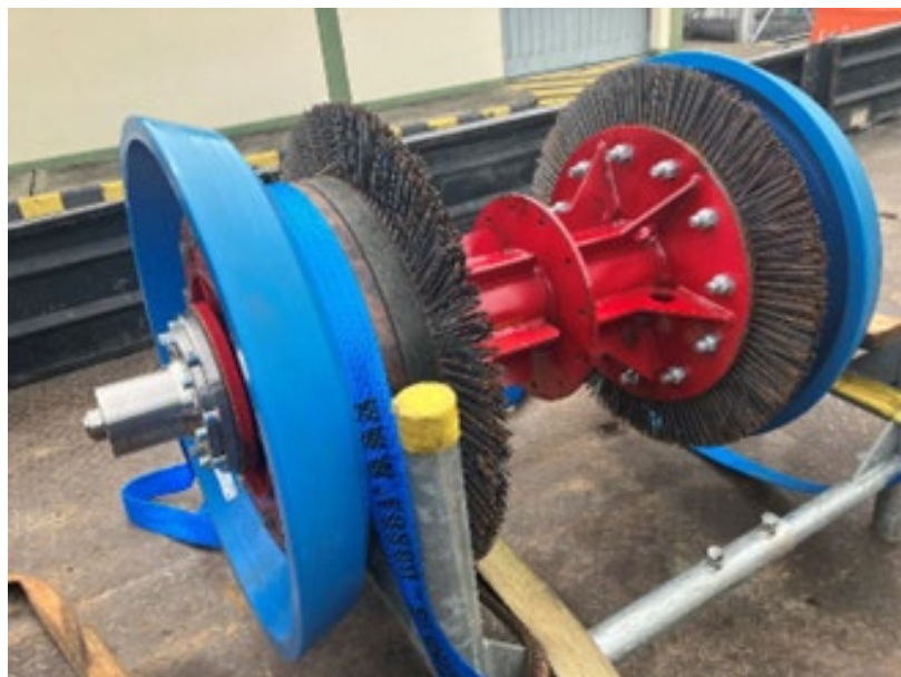
Fotografía 1. Herramienta de limpieza de tuberías con unidad de mapeo integrada.
