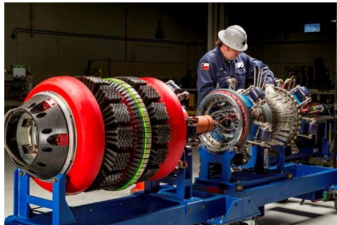
Figura 3 MFL 36” con by pass variable y modulo geométrico (herramienta tipo combo) de la Empresa BJS
