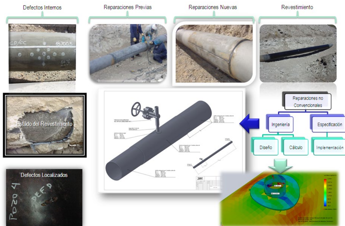
Figura 11. Alcance de la inspección directa en cañerías.
