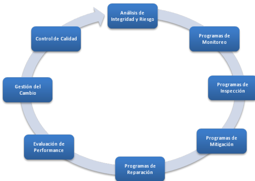
Figura 1. Proceso de gestión de corrosión.
