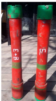
Figura 1. Probetas para prueba de patio remediación de cabezales.
