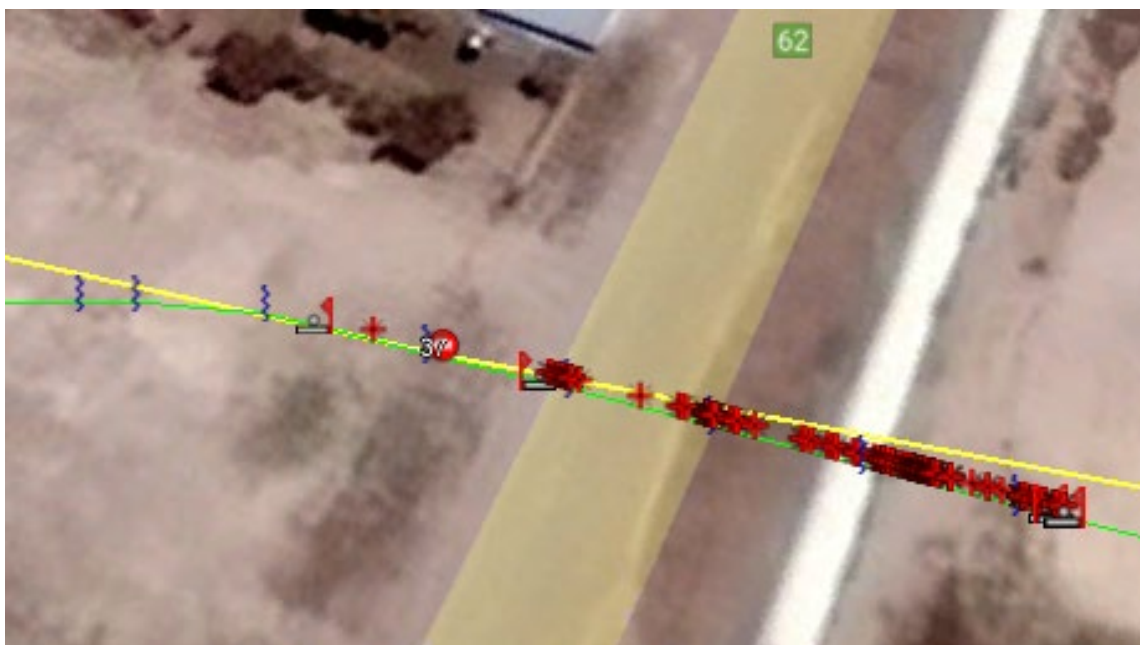
Fig. 7 – Imagen de la segunda corrida en la zona del caño camisa, donde se ve claramente como todas las fallas se encuentran entre el comienzo y el fin de la zona del espacio anular desprotegido.
