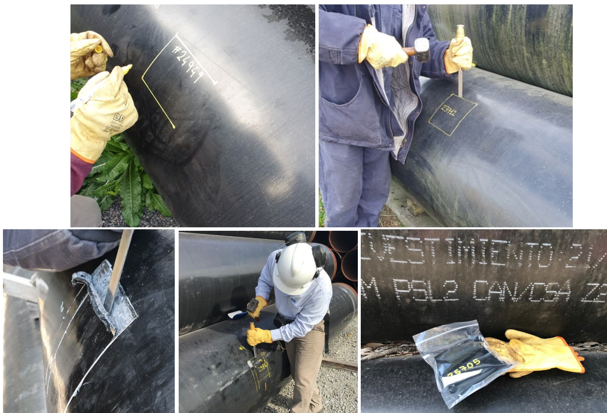
Figura 4a – 4b – 4c - 4d - 4e. Extracción de muestras de recubrimiento.
