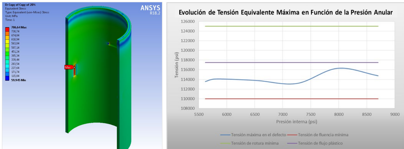
Figura 16. Tensión equivalente (Von Mises) en sección dañada (izquierda). Distribución de tensión equivalente máxima en función de la presión anular (derecha).
