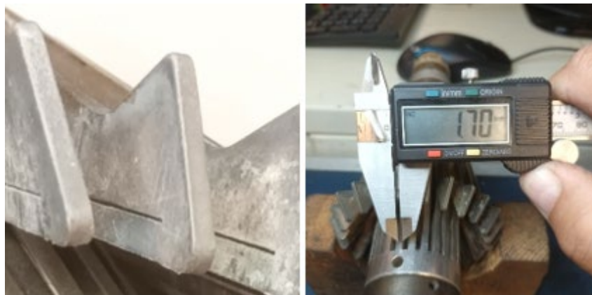
Figura 6. a) Perfil de un palpador en buen estado — b) Espesor del palpador
