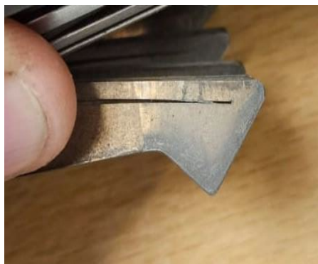
Figura 4. Perfil de un palpador en uso en buen estado.
