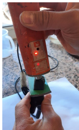
Figura 3. Medición de continuidad con detector de Holiday Elcometer 270
