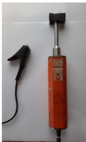
Figura 3. Medición de continuidad con detector de Holiday Elcometer 270
