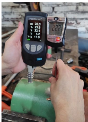
Figura 6. Medición de Temperatura antes y durante el Proceso de Soldadura
