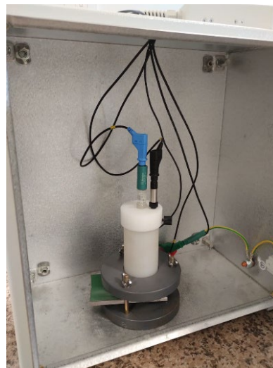
Figura 10. Celda electroquímica con muestra de probeta caño PV2, dentro de la caja de Faraday.
