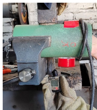
Figura 2. Diseño de ensayo para la medición de la temperatura durante la soldadura
