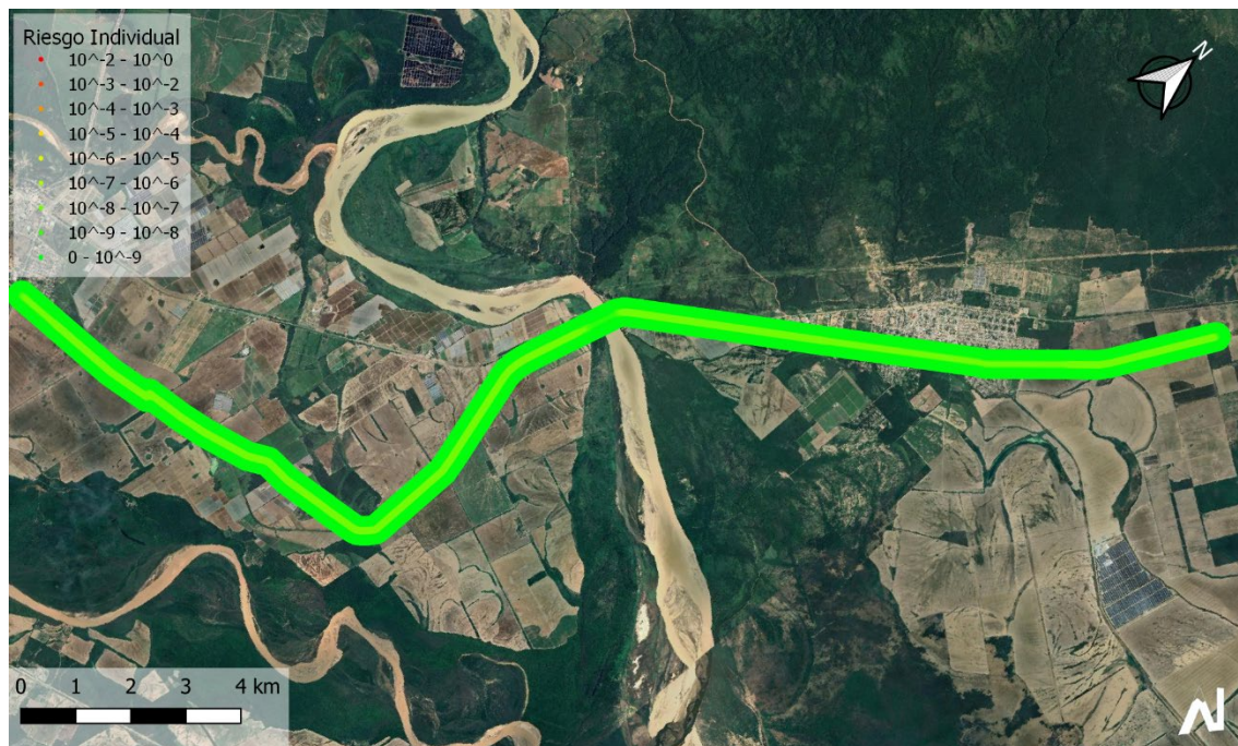
Figura 11. Riesgo individual a lo largo y ancho de la traza. EGIG.
