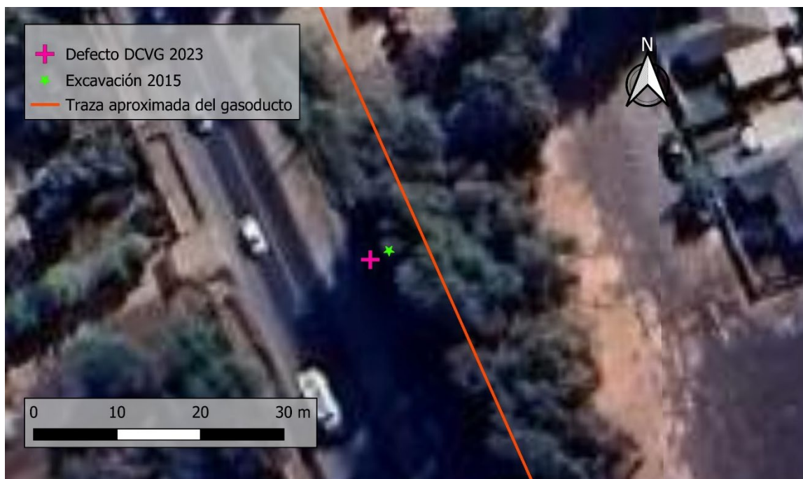
Figura 7. Ejemplo de coincidencia de excavación pasada con defecto DCVG actual.
