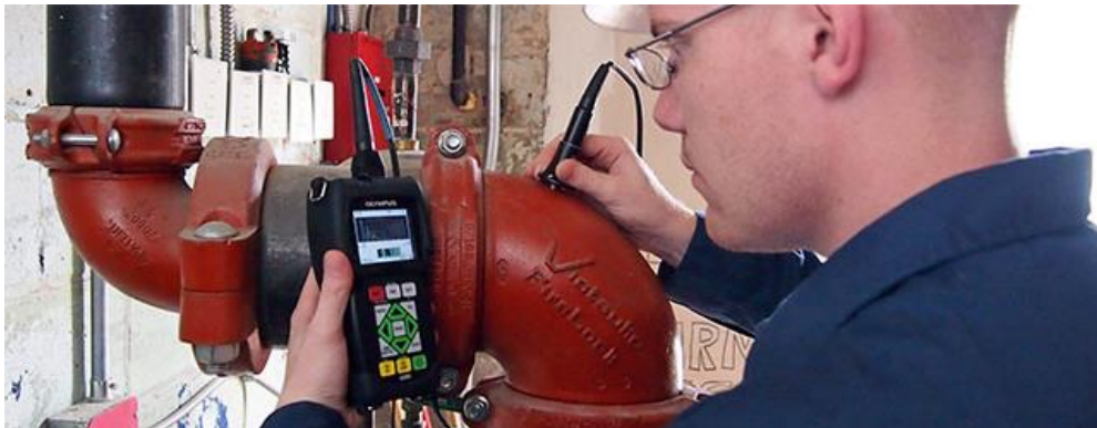
Fig. 3: Medición de espesor en codos, con un medidor por Ultrasonido Convencional con pantalla A-Scan.
