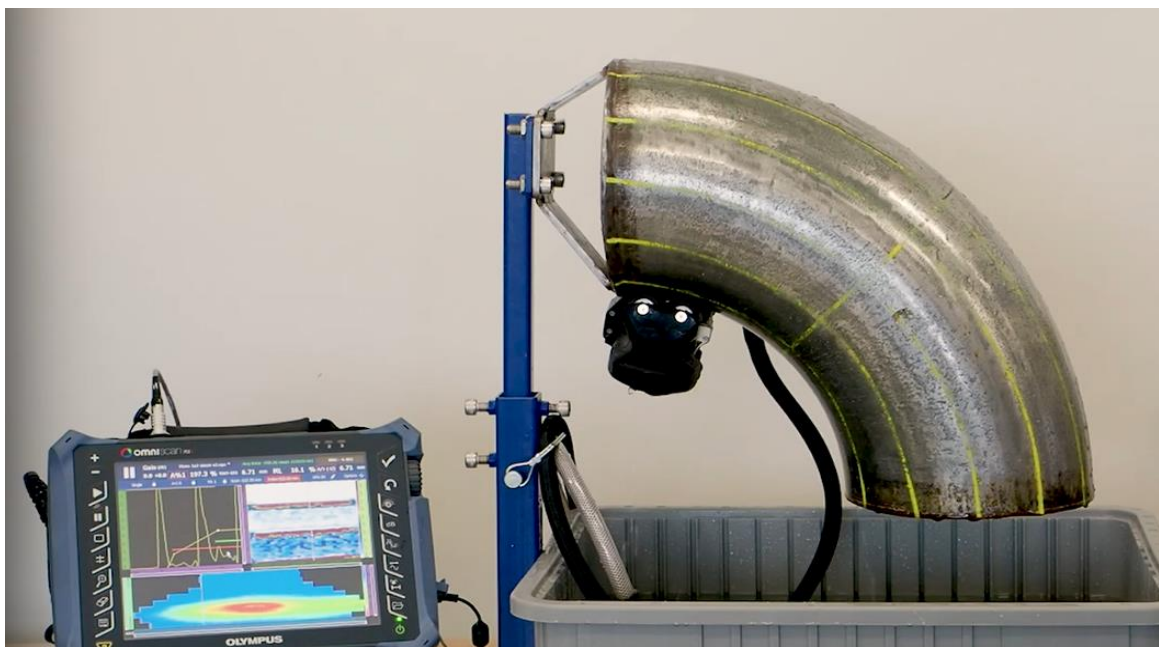
Fig. 13: Inspección completa de codo de acero al carbono. En este caso, el escáner está posicionado en el radio interior.
