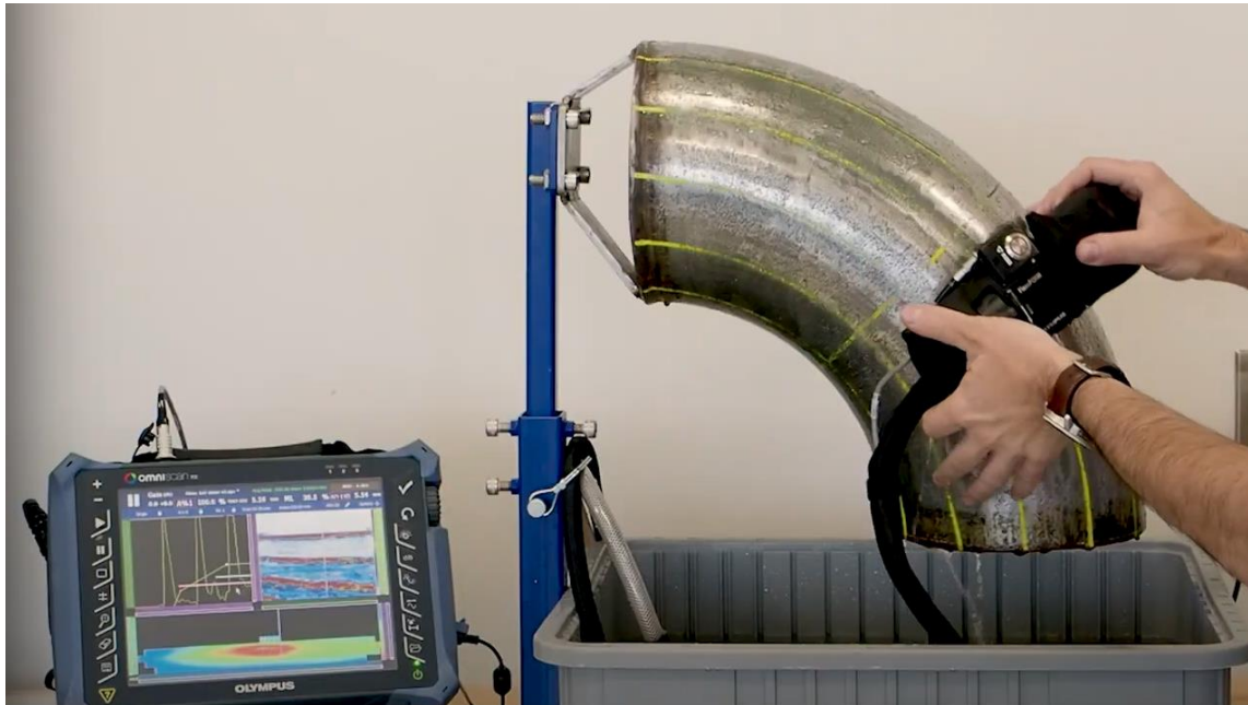
Fig. 12: Inspección completa de codo de acero al carbono.
