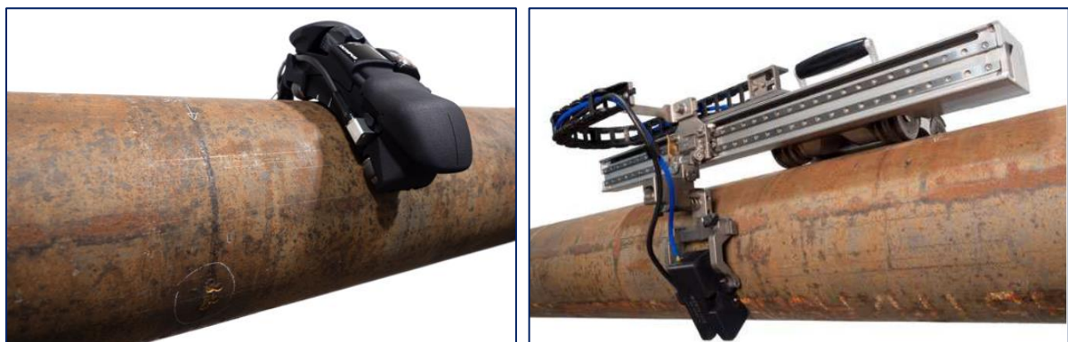
Fig. 23: Uso del transductor flexible y dispositivo en inspección de corrosión de cañerías. Para aquellos casos en los que se busca aumentar la productividad, puede ser instalado en un escáner automático.
