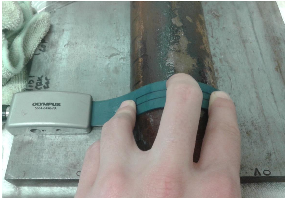
Fig. 7: Transductor de 64 elementos, 5 MHz de frecuencia y array flexible, sobre una cañería de 4 in de diámetro.
