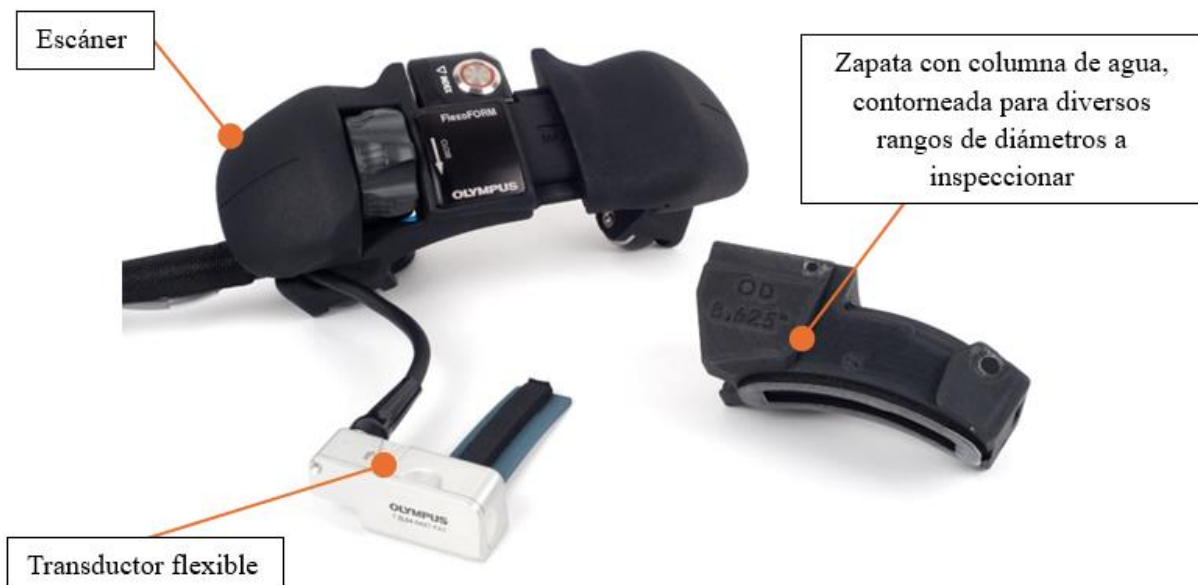
Fig. 11: Partes principales del escáner FlexoFORM: piezas fundamentales para realizar mapeos de corrosión en codos.
