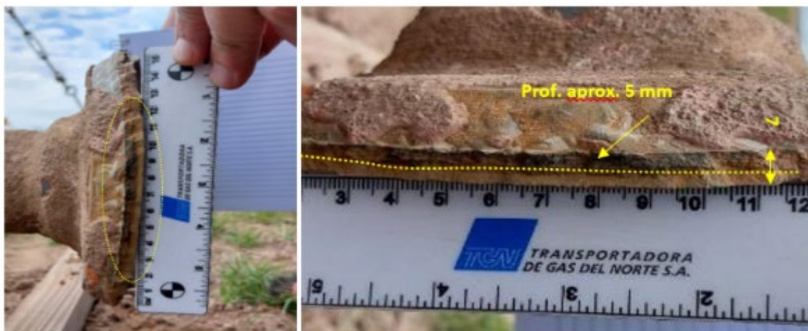
Figura 3. Fractura en la soldadura entre poncho y ducto.
