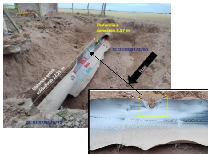
Figura 2. Tramo afectado por la falla en servicio, dimensiones. Inserto: ubicación de la acometida en el centro del tramo averiado.
