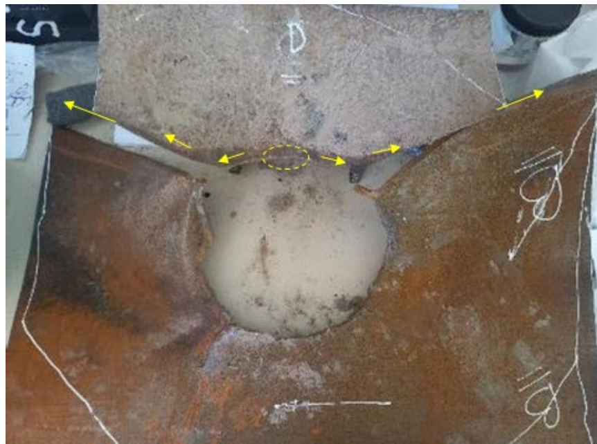
Figura 6. Sitio de iniciación y sentido de propagación de las fracturas al momento de la falla en servicio.
