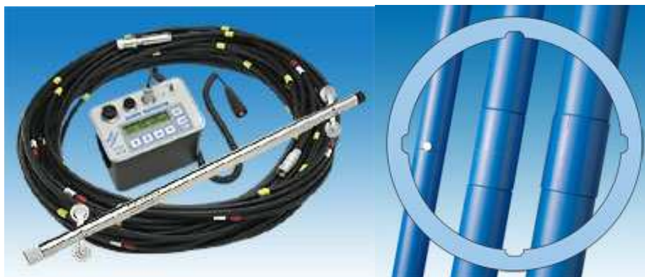
Figura 18. Sonda de medición y camisa de PVC
