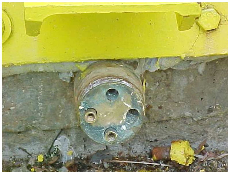
Figura 13. Cabezal de extensómetro de roca con 4 varillas
