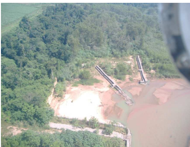
Figura 40: espigones de gaviones
