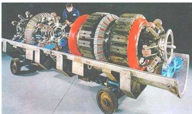
Figura N° 5 – Herramienta de Inspección Interna de Alta Resolución
