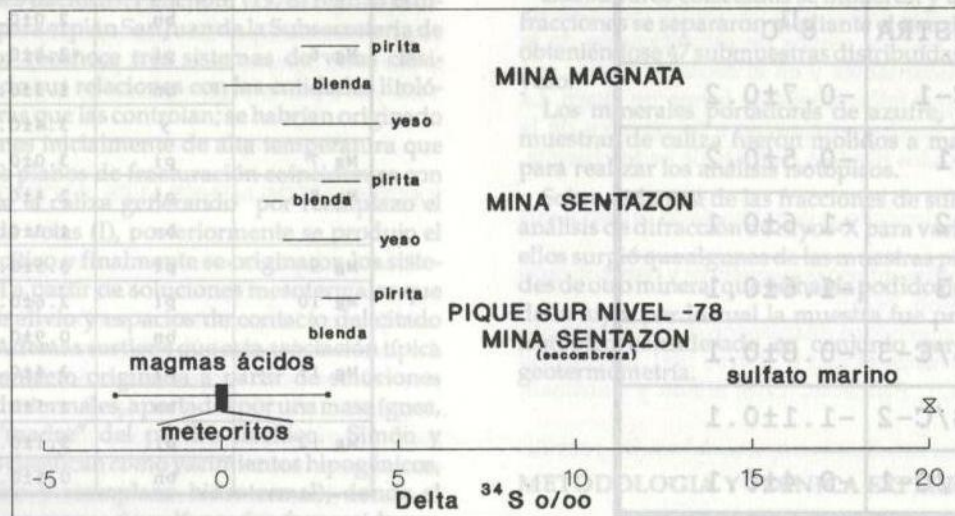
Figura 2: Rango de valores ^{34}\text{S} de los minerales pirita, blenda y yeso, donde ^{34}\text{S}_{\text{pirita}} > ^{34}\text{S}_{\text{blenda}} > ^{34}\text{S}_{\text{yeso}} . Referencias comparativas rango de valores ^{34}\text{S} de meteoritos, magmas ácidos y sulfato marino.
