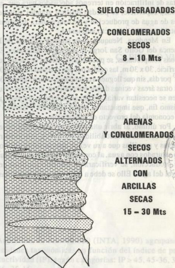
Figura 1: Perfil ideal para infiltrar agua en estratos horizontales.
