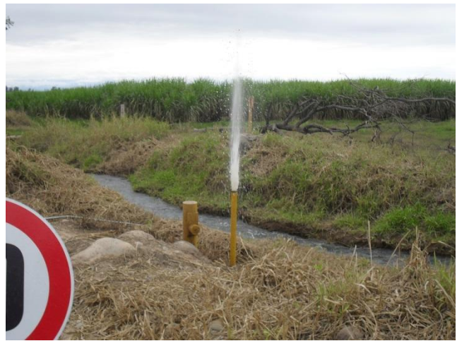
Fotos 1y 2 – Verificación de circulación de aire y eliminación del agua en el interior del caño camisa
