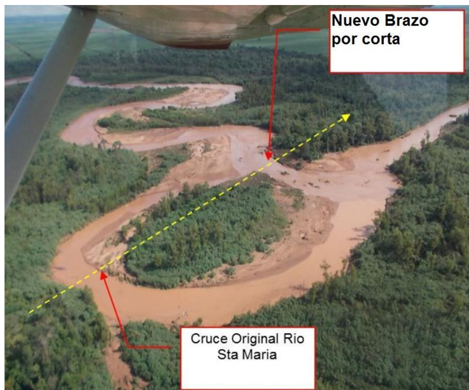
Figura 21. Cruce del Río Santa María – Corta natural del meandro después del cruce especial
