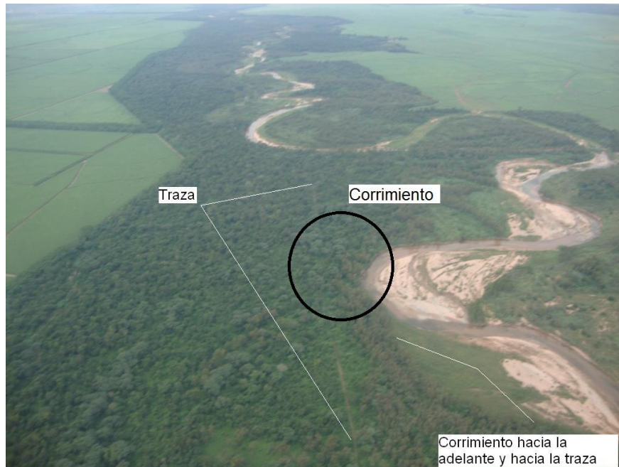
Figura 22. Vista hacia aguas abajo del río – Se aprecia la traza y el meandro que se acerca a la traza
