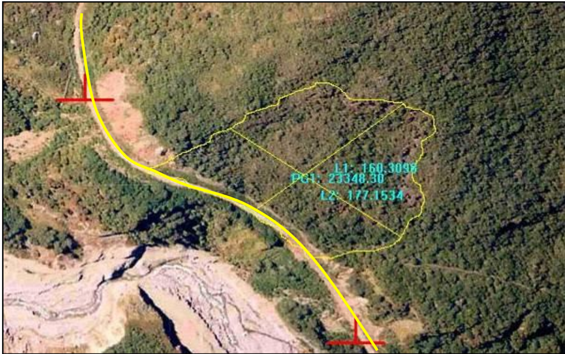
Fig. 4: Fotografía aérea escala 1:10000, que muestra los límites aproximados del talud, la línea amarilla representa el gasoducto.
