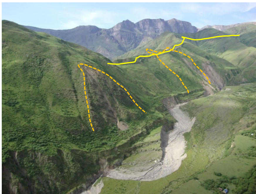
Fig. 2: Paisaje característico del extremo este de la Cordillera frontal. Atrás en el fondo, el frente de fracturación principal. En amarillo la línea de gasoducto del tramo 501 a la altura del M+m 105. En líneas de trazo naranja, cicatrices de antiguos deslizamientos.
