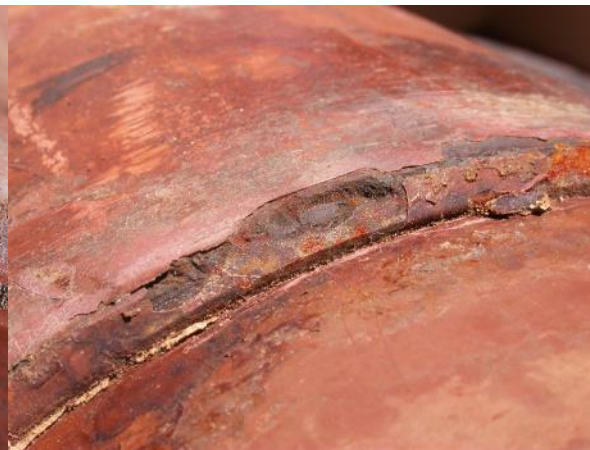
Fig. 9. Desprendimiento de coating y corrosión con pérdida de material en el borde de junta 2B.
