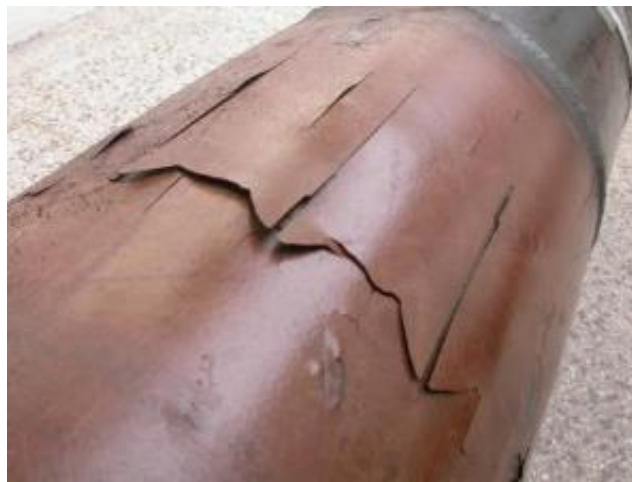
Fig.28. Muestra 2 post ensayo. Delaminación del recubrimiento epoxi debido a deformación plástica circunferencial, lado B, similar al de la muestra 1.
