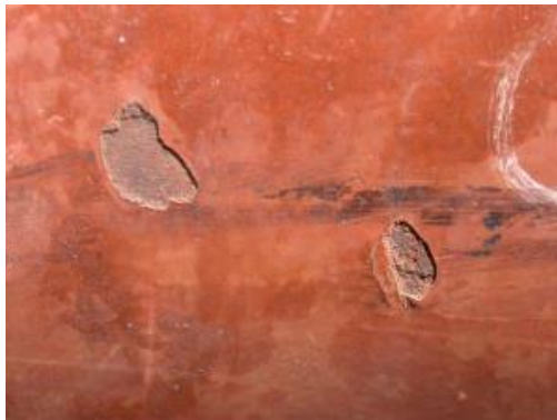
a) b) Fig. 8. a) Desprendimiento de coating en el cuerpo de la muestra 2. b) Indentaciones superficiales circunferenciales sobre el coating de aspecto reciente.
