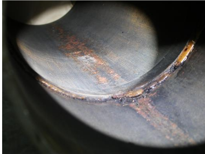
Fig. 11. Banda longitudinal de corrosión.
