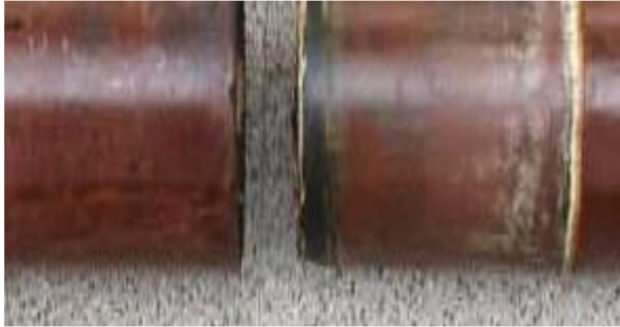
Fig. 27. Muestra 2. post ensayo. Separación de junta.
