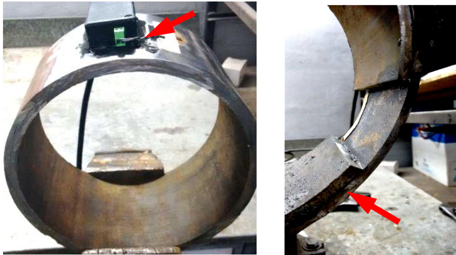
Fig.31. Junta embonada de 8". Instrumentación y corte de sector interno de sector. Virola del plano medio de la junta.
