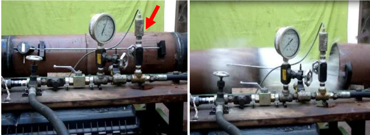
Fig. 24: Ensayo destructivo de la junta. A la izquierda, instantes previos, se indica la zona de deformación plástica del lado B. A la derecha, el instante de la separación de la junta.
