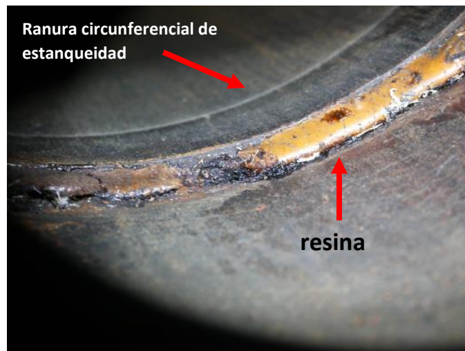
Fig. 12. Remanentes de resina epoxi con desprendimiento en el borde 2A. Detrás, el pliego de la ranura de almacenamiento de resina.
