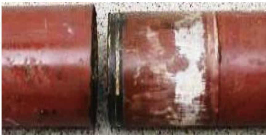
Fig. 25. Muestra 1 post ensayo. Separación de la junta.
