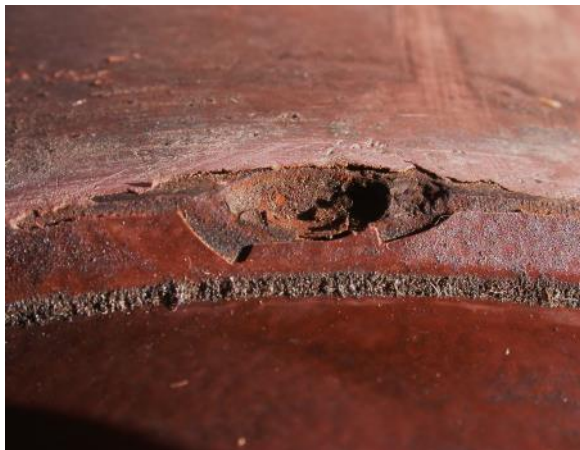
Fig. 9. Desprendimiento de coating y corrosión con pérdida de material en el borde de junta 2B.
