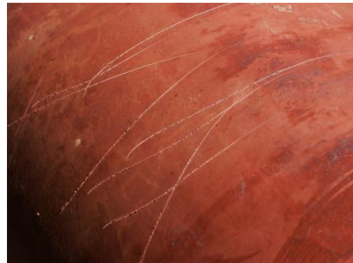
a) b) Fig. 8. a) Desprendimiento de coating en el cuerpo de la muestra 2. b) Indentaciones superficiales circunferenciales sobre el coating de aspecto reciente.
