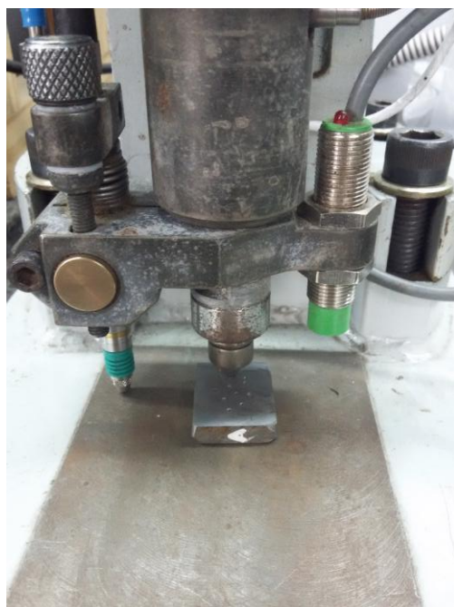
Figura 10. Indentador ensayando las muestras.
