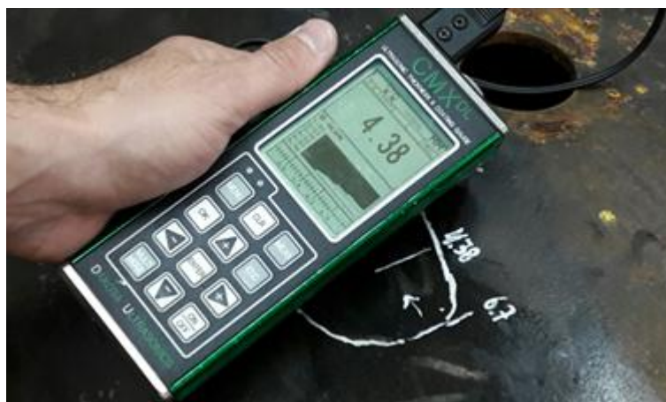
Imagen 6. Caracterización de extremo de laminación con UT.
