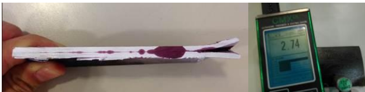
Imagen 7. Caracterización del perfil de una laminación paralela con UT.
