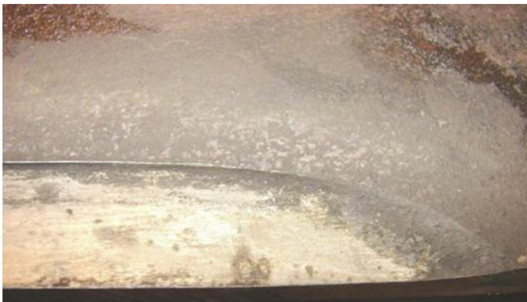
Imagen 15. Cupón laminación abierta hacia adentro luego de extraída la escama.
