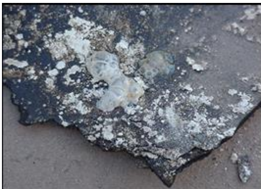
Fotografía 2: Evaluación cualitativa de productos de corrosión con el agregado de ácido.
