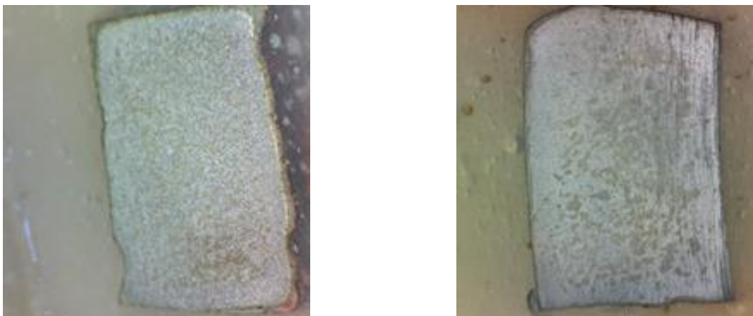
Figura 5: fotografías de las muestras ensayadas en la solución de INHIB 1, con 100 ppm (izquierda) y en el electrolito sin inhibidor (derecha).
