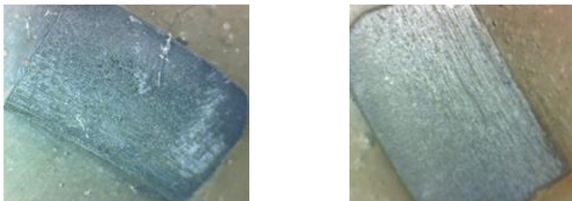
Figura 13: Fotografías de las muestras ensayadas bajo las soluciones de INHIB 3 para 50 ppm (izquierda) 150 ppm (derecha).
