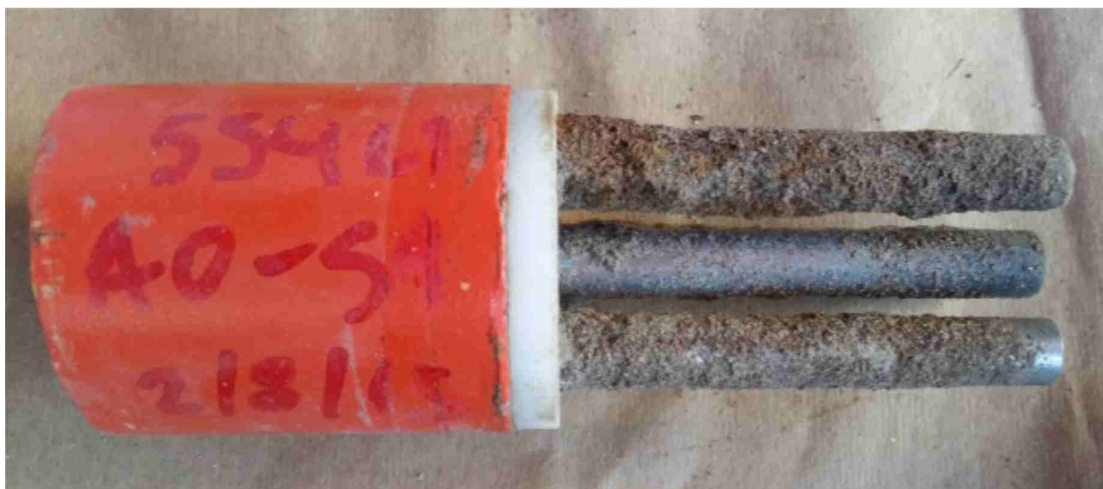
Figura 13. Fotografía de cupón con productos de corrosión..
