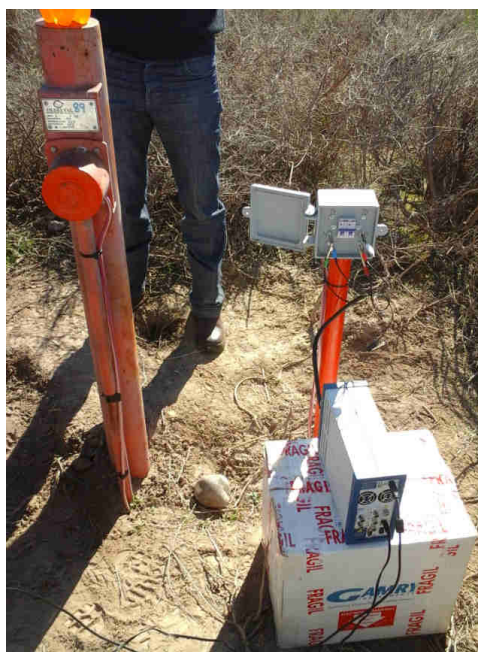
Figura 11. Fotografía de medición en campo con potencióstato.
