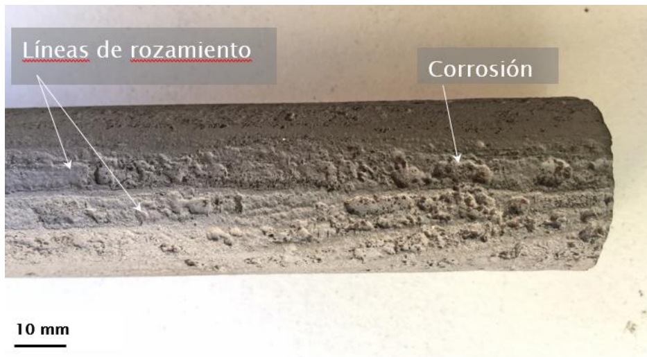
Figura 3. Falla en Pozo 2.
