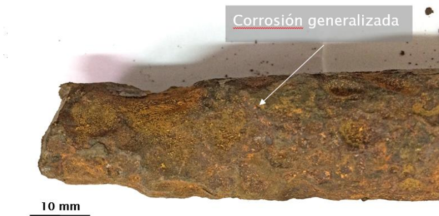
Figura 4. Falla en Pozo 3.
