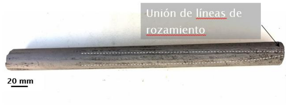
Figura 2. Falla en Pozo 2.
