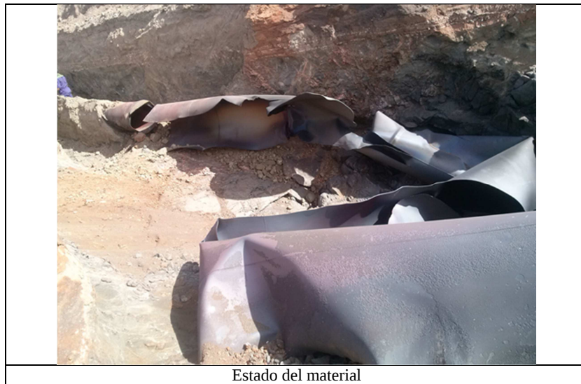
Figura 3.- Estado de las chapas luego de la ignición
