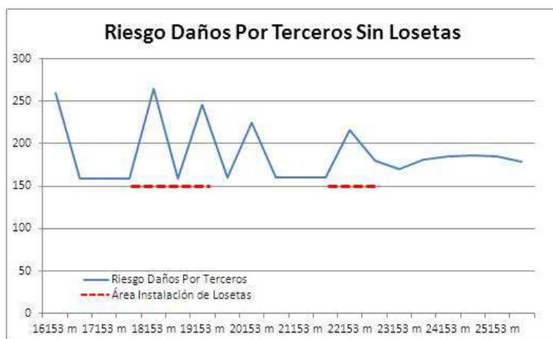
Figura 10 – Riesgo Daños por Terceros Sin Losetas de Protección
