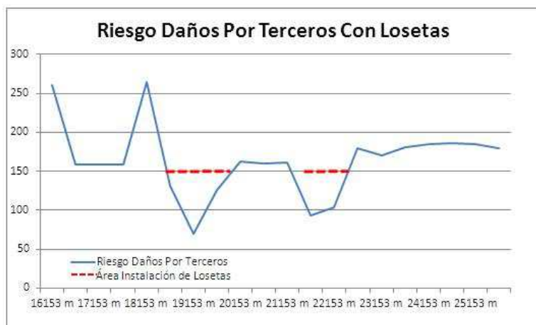
Figura 11 – Riesgo Daños por Terceros Con Losetas de Protección
