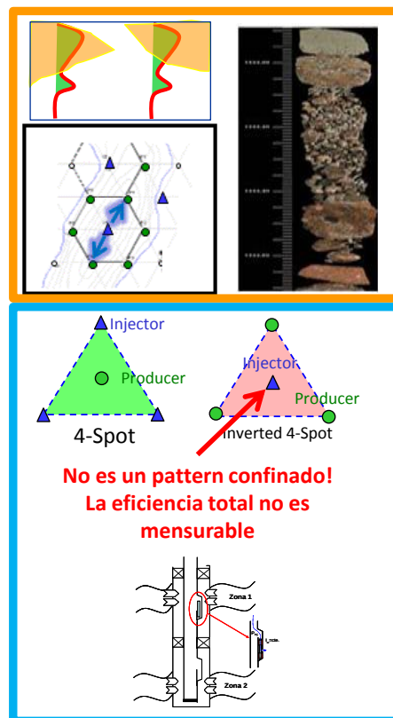
Figura 14: Problemas Asociados a Reservorios y a Diseño Implementación Monitoreo y Seguimiento de Procesos de WF
