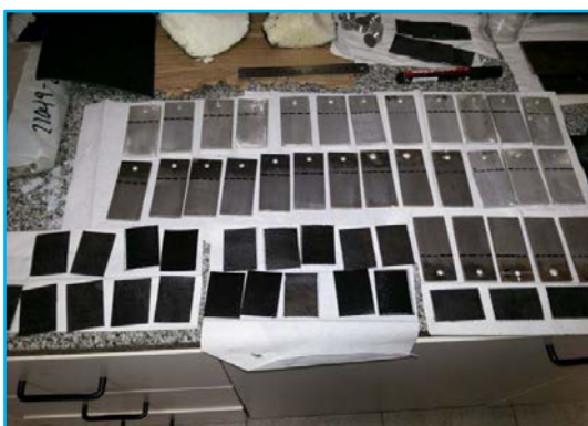
Fig. N° 5. Preparación de la superficie sobre las probetas de acero y membrana.
