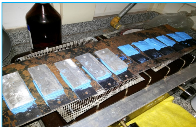
Fig. N° 8. Aplicación del Sistema: Probeta de acero al carbono + sellador + membrana de teflón + sellador + probeta de Aluminio.
