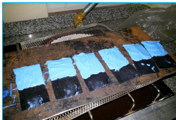
Fig. N° 7. Aplicación del producto sellador en las láminas de membrana.
