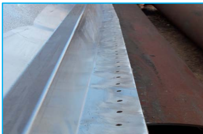
Fig. 19. Aspecto de la superficie del “faldón” después del tratamiento de limpieza – “superficie de referencia.”
