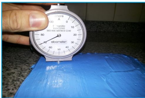
Fig. N° 9. Medición de dureza sobre probeta con curado a bajas temperaturas.
