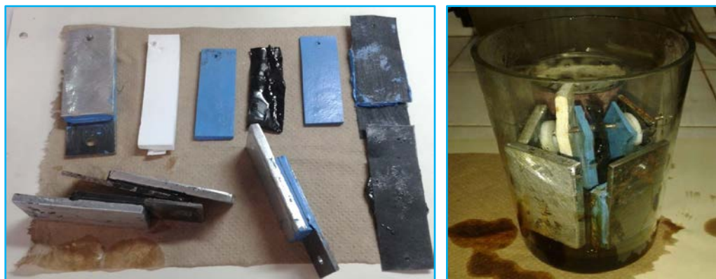
Figs. N° 13. Evaluación de las muestras transcurrida 7 días de exposición en Autoclave.
