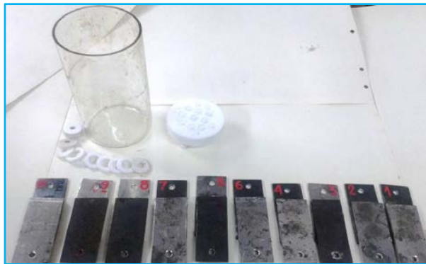
Fig. N° 1. Liner de vidrio, arandelas de teflón y probetas, para el armado del ensayo.
