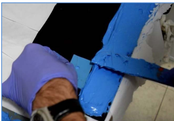
Fig. 15. Control de espesor de capa húmeda con la “galga testigo”.
