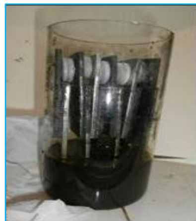
Fig. N° 3. Probetas dentro del liner del autoclave.
