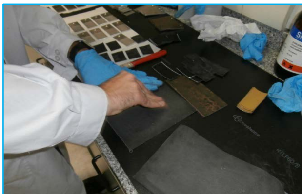
Fig. N° 6. Preparación de superficie de las probetas de la lámina de teflón.
