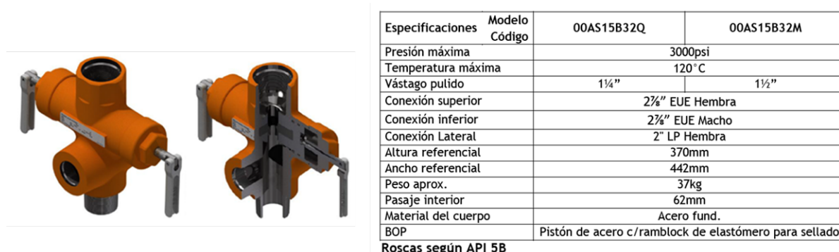
Figura 15 – BOP con posibilidad de purga inferior
