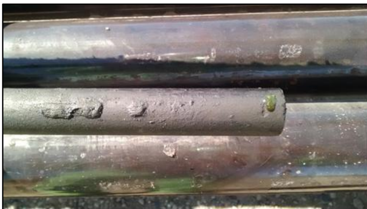
Ilustración 8: Zona de inicio de picado, depósitos y reacción obtenida con BAROID (Sulfuro de Fe)
