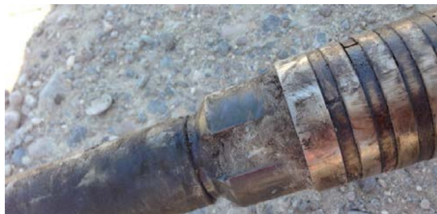
Fig. 2. Descarga del pistón completamente tapada por deposición de asfaltenos/parafinas
