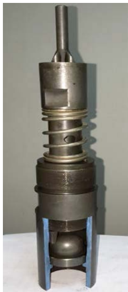
Fig. 3. VR con jaula lisa seccionada, mostrando la cuchara de accionamiento. Obsérvese que la descarga posee un perno corto para la apertura de la válvula móvil
