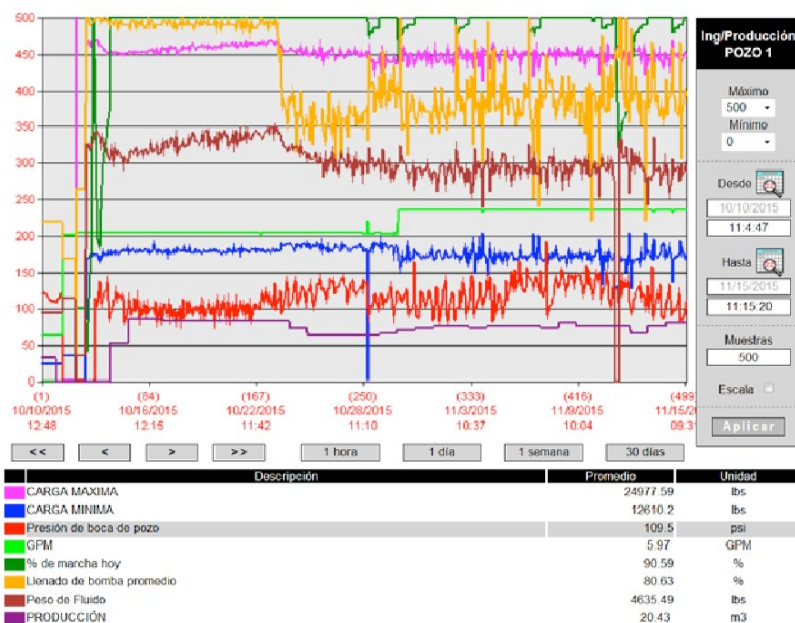
Fig. 11. Tendencias del pozo 1. Se aprecia el momento en que el peso de fluido llega a un máximo a partir del cual comienza a ingresar gas a través de la bomba
