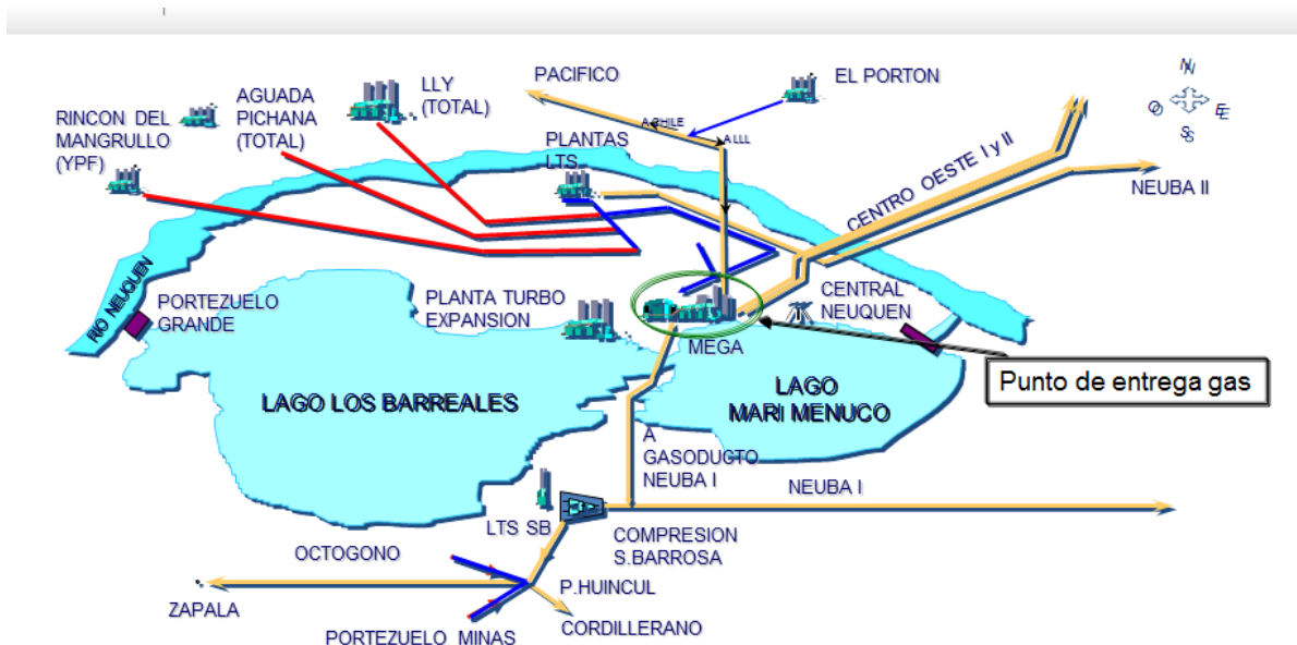
Figura 2 – Red de gasoductos, plantas y terminales de Loma La Lata
