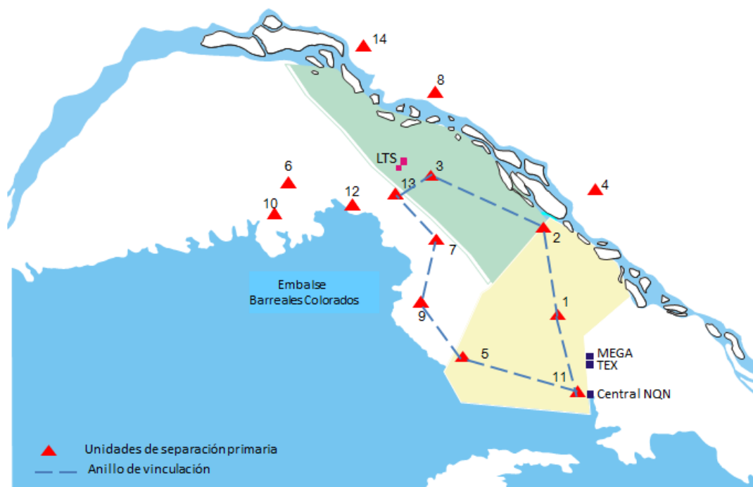
Figura 3 – Esquema de Unidades de Separación Primaria y gasoducto de vinculación de Loma La Lata
