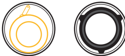
Figura.7: Comparación entre anclas de torque de agarre por Aleta (Izq) y de agarre por mordaza (Der)
