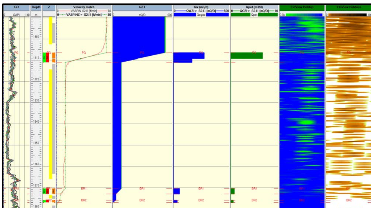
Figura 6: Perfil trifásico del segundo pozo en que se realizaron (100% del petróleo producido de la formación Papagayos proviene del ático).
