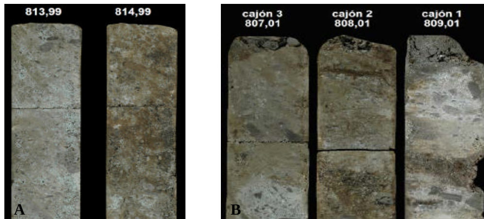
Figura 3. Contenido de arcillas como control de impregnación de hidrocarburos (A) y Cemento de calcita como control de la impregnación (B). Detalles de fotografía corona con luz natural.
