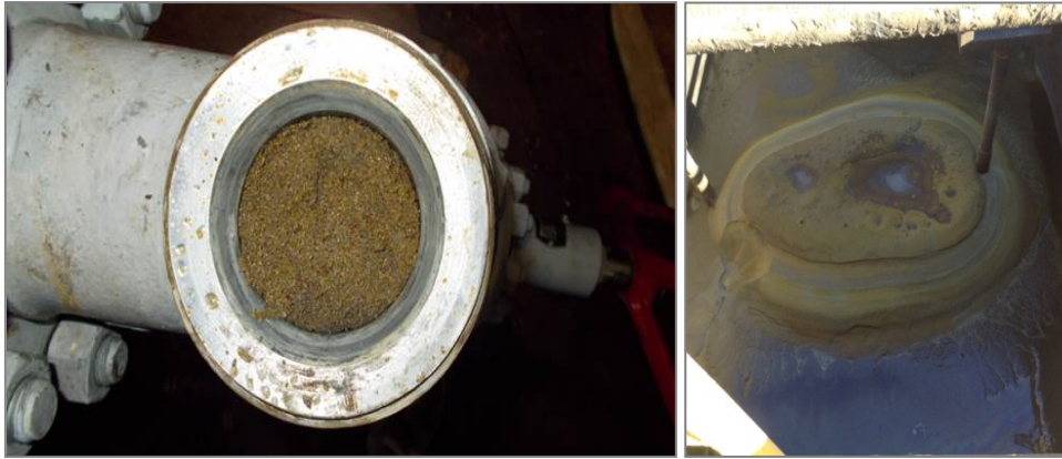
Figura 14. Taponamiento de codo y arena devuelta a pileta durante ensayo en pozo de RDM
