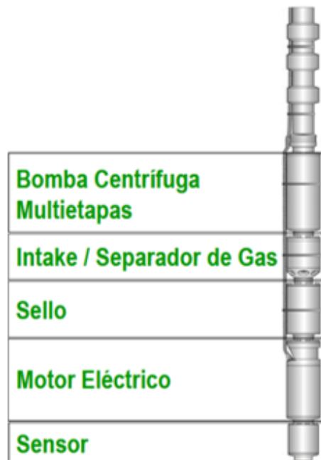
Figura 1. Esquema del equipo de fondo de pozo de una BES.
