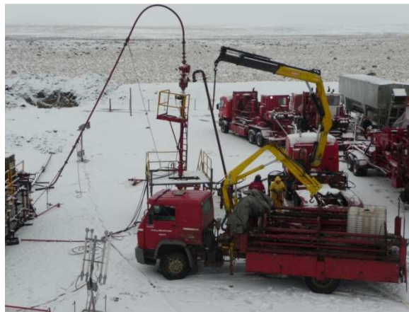
Figura 4: Se usó tree-saver y omega, y se permitió la apertura inmediata del pozo posterior a la fractura.
