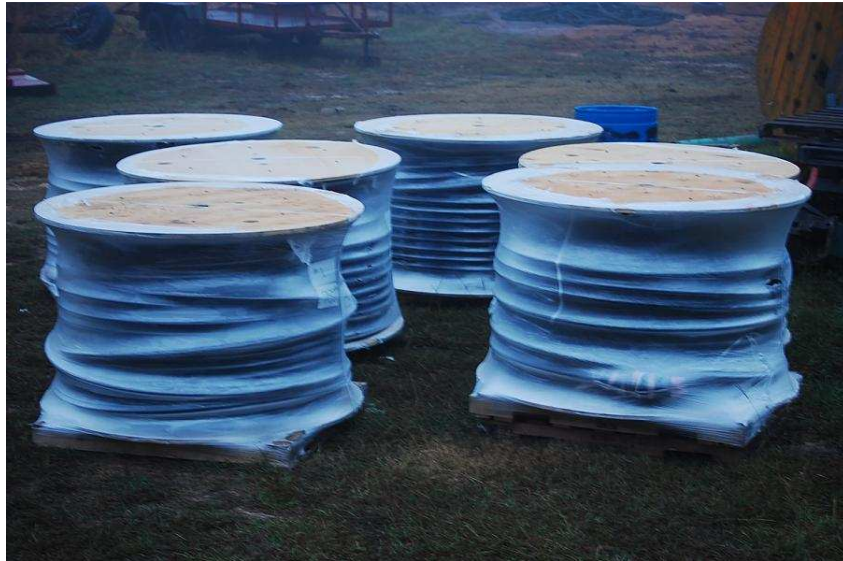
Seis carretes de tubería tal como es recibido de fábrica
