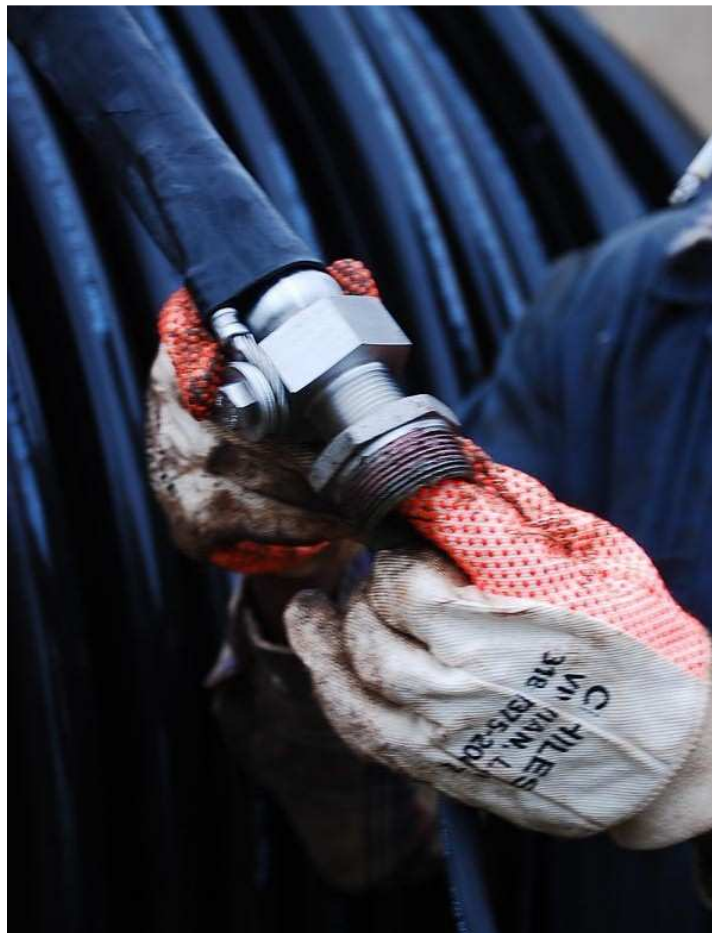
Detalle de los extremos de la manguera mostrando el accesorio de conexión
