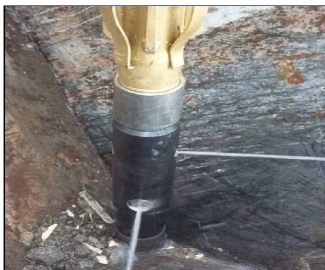
Figura 9. Prueba de circulación sobre jets.
