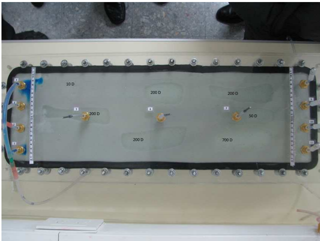
Figura 22: Celda con cuerpos arenosos de alta permeabilidad rodeados por una arena continua de menor permeabilidad. Se muestra el inicio de la inyección de un pulso de un trazador de color azul.
