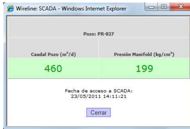
Figura 12: Datos de Caudal y Presión obtenidos de red SCADA
